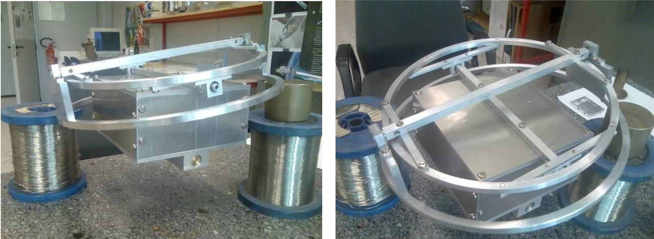
**Figura 1: struttura autoallineante a giunti cardanici**
